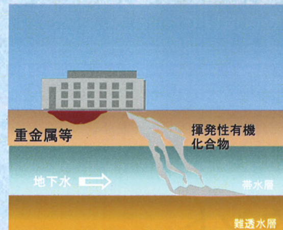
土壤・地下水汚染の概念図
