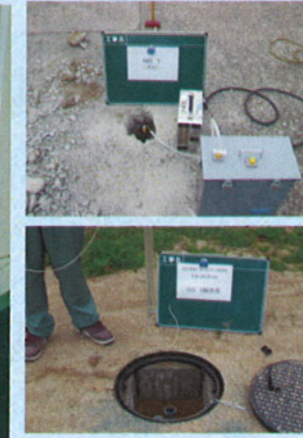
土壤ガス濃度調査(上部) 地下水観測井の設置・モニタリング(下部)
